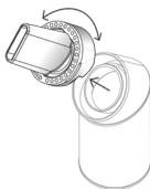
Демонтаж насадки с узким соплом
