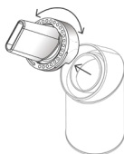
尖先吸口を取り外し
